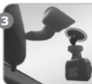
Зафиксируйте видеорегистратор на 3М креплении на лобовом стекле автомобиля в предварительно выбранном месте.
