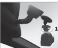
Ослабьте контргайку **1**, повернув ее против часовой стрелки. Отрегулируйте положение регистратора на креплении и задайте направление съемки. Зажмите контргайку **1**, повернув ее по часовой стрелке.
