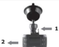
Для снятия видеорегистратора с крепления сначала надавите на язычок **1**. Затем, удерживая язычок, отсоедините регистратор с крепления, сдвинув его в сторону **2**.
