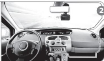
Установите видеорегистратор и проложите кабель питания примерно так, как показано на рисунке, используя набор монтажных клипс. Распределите клипсы на лобовом стекле равномерно для закрепления провода питания.
