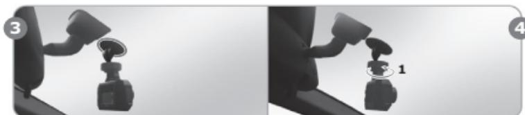
Зафіксуйте відеореєстратор на 3М кріпленні на лобовому склі автомобіля в попередньо обраному місці.
